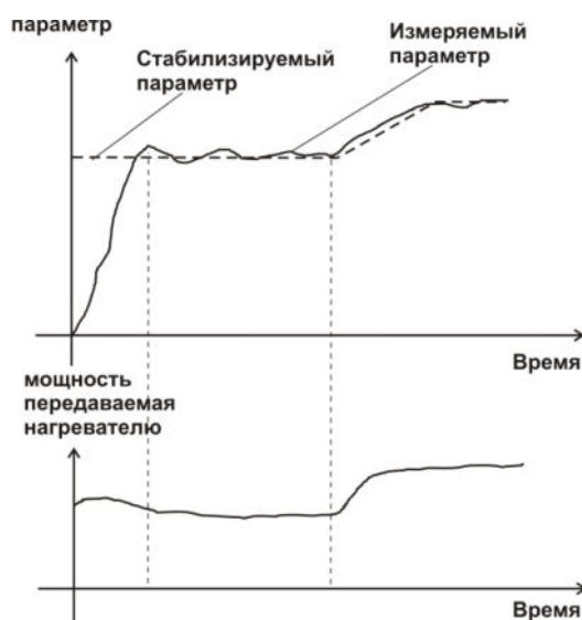
Рисунок 3.13 Стабилизация по ПИД закону
