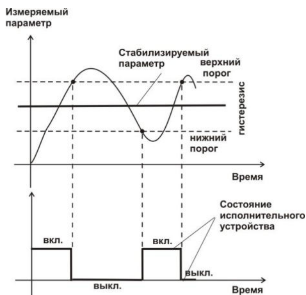
Рисунок 3.12 Стабилизация с гистерезисом
